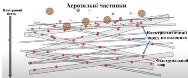
Рисунок 2.10 – Візуалізація уловлювання аерозольних частинок фільтрувальним шаром з електростатичним зарядом
