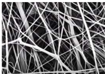
Рисунок 2.9 – Структура фільтрувального матеріалу (збільшення в 300 разів)
