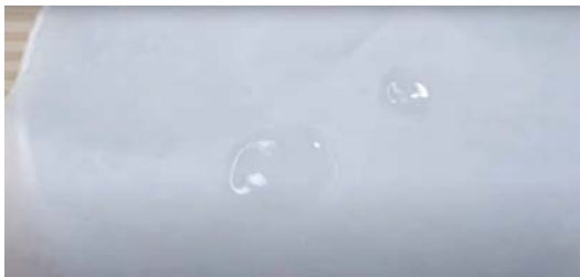
Рисунок 2.15 – Вигляд каплі води на фільтрувальному матеріалі
