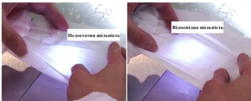
Рисунок 2.12 – Перевірка щільності упакування волокон за допомогою проникності світла
