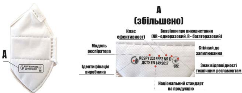
Рисунок 2.3 – Маркування респіратора за вимогами чинного законодавства
