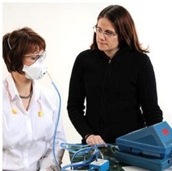
Рисунок 2.2 – Вхідний контроль респіраторів за допомогою PortaCount Plus
