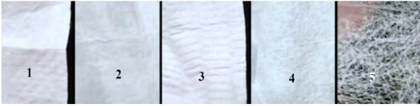
Рисунок 2.13 – Порівняння фільтрувальних матеріалів за щільністю упакування волокон
