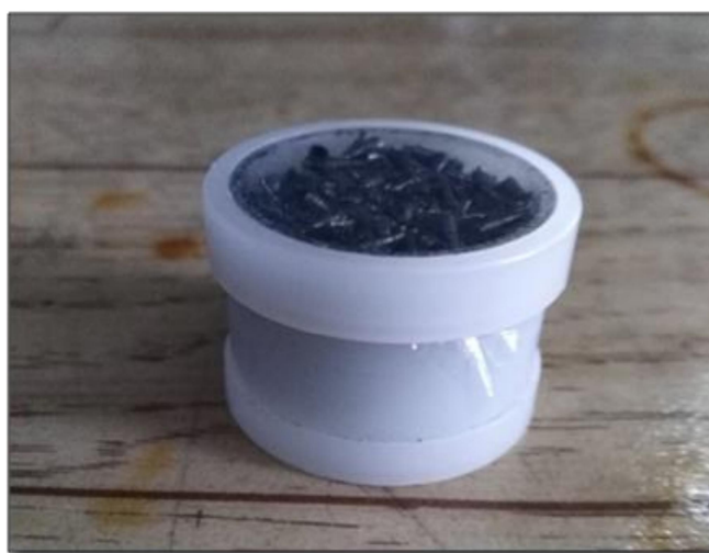
Рисунок 1 – Наважка озоленої проби, підготована до аналізу на рентгенофлуоресцентному спектрометрі ElvaX
