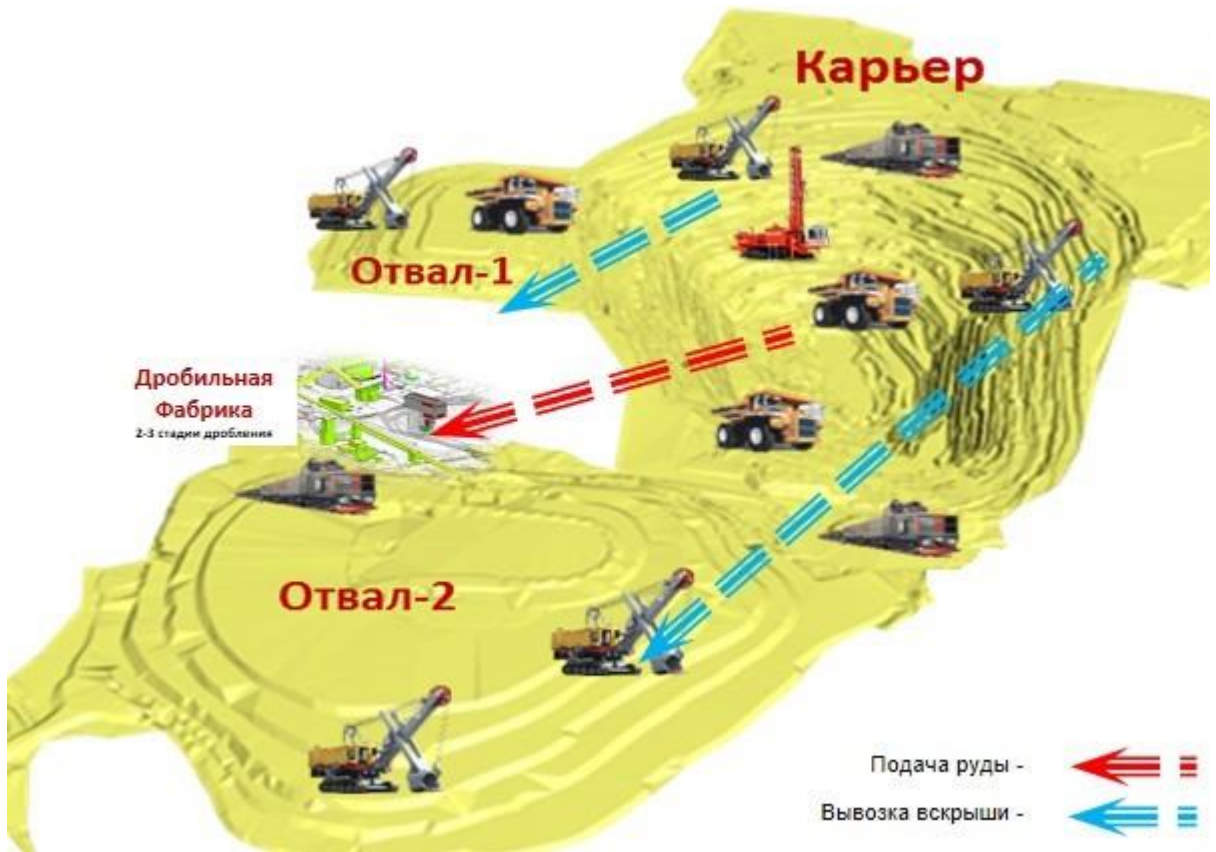
Рисунок 2.7 - Схема подання руди та вивезення розкривних порід
