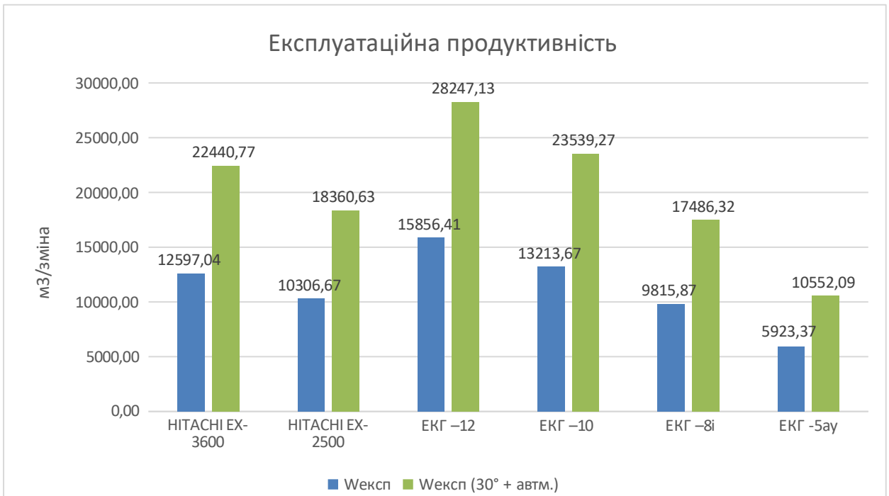
Рисунок 3.5 - Діаграма порівняння експлуатаційної продуктивності поточного завантаження з автоматизованим завантаженням при 30°
