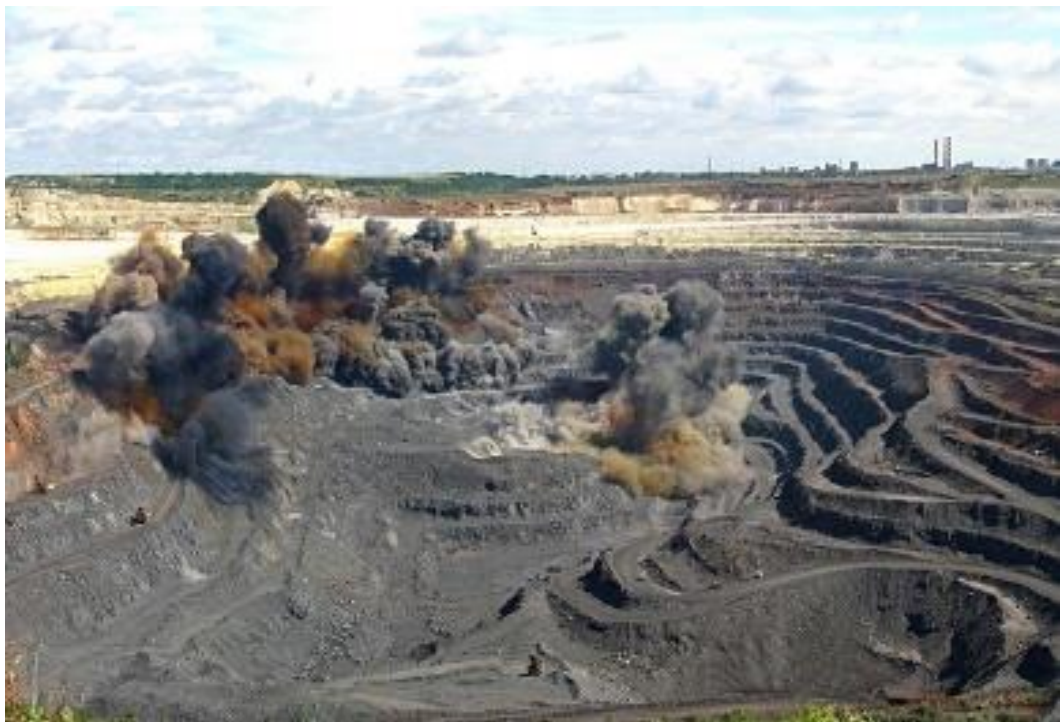
Рисунок 2.4. – Проведення масового вибуху
