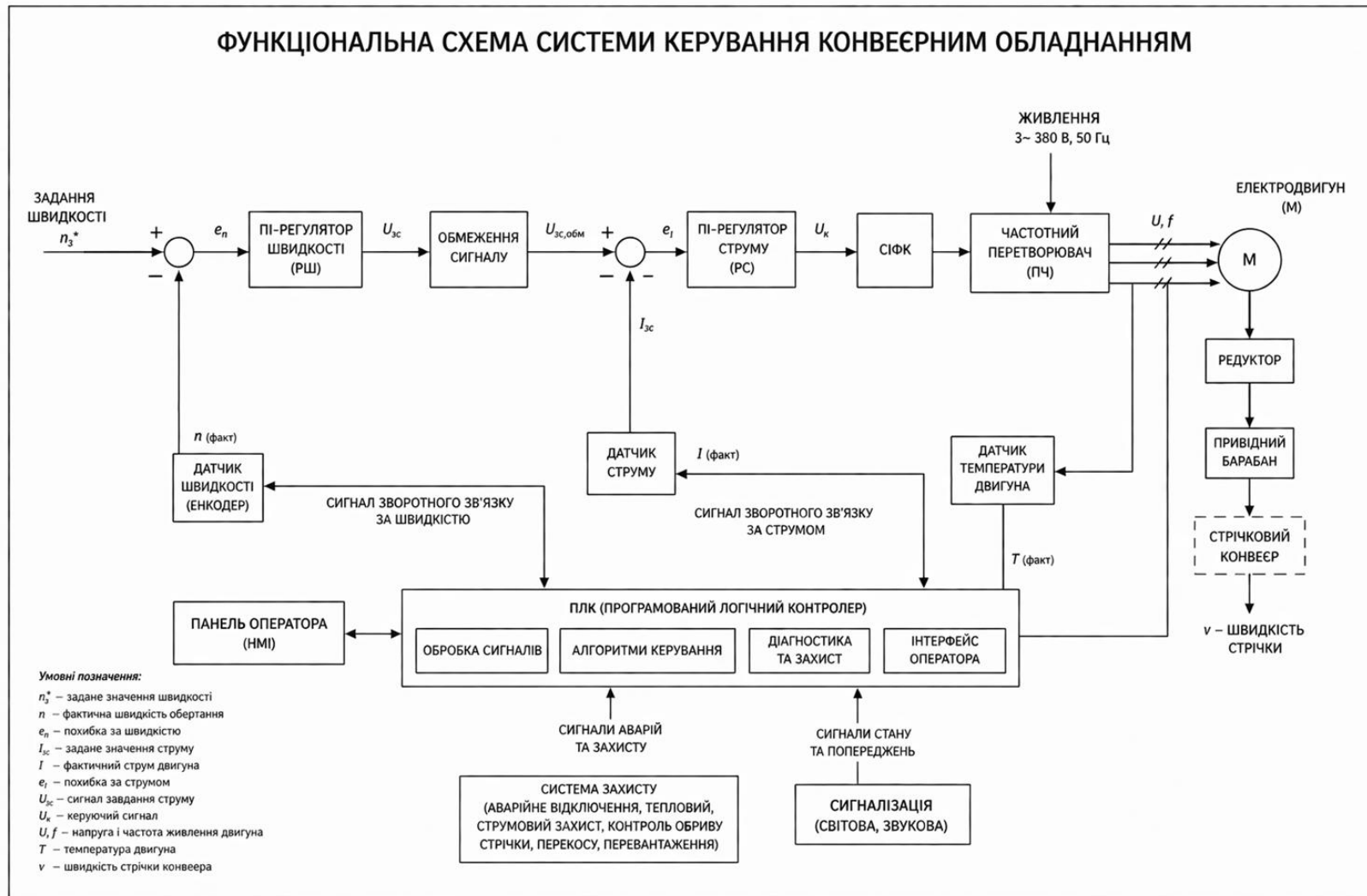
Рисунок Е – Функціональна схема системи керування конвеєрним обладнанням
