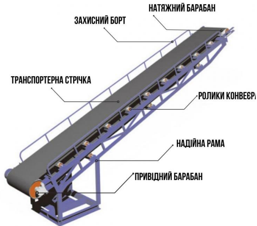
Рисунок 1.1 – Загальна схема стрічкового конвеєра
