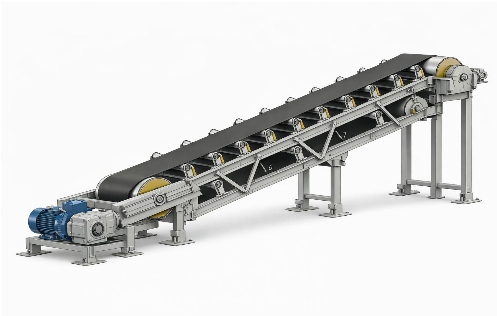
Рисунок В – 3D модель стрічкового конвеєра з електроприводом
