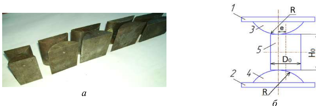
1 и 2 – верхняя и нижняя осадочная плита; 3 и 4 – верхний и нижний радиусный боек; 5 – заготовка Рисунок 1 – Набор бойков для проведения эксперимента (а) и схема асимметричной осадки заготовки радиусными бойками (б)
