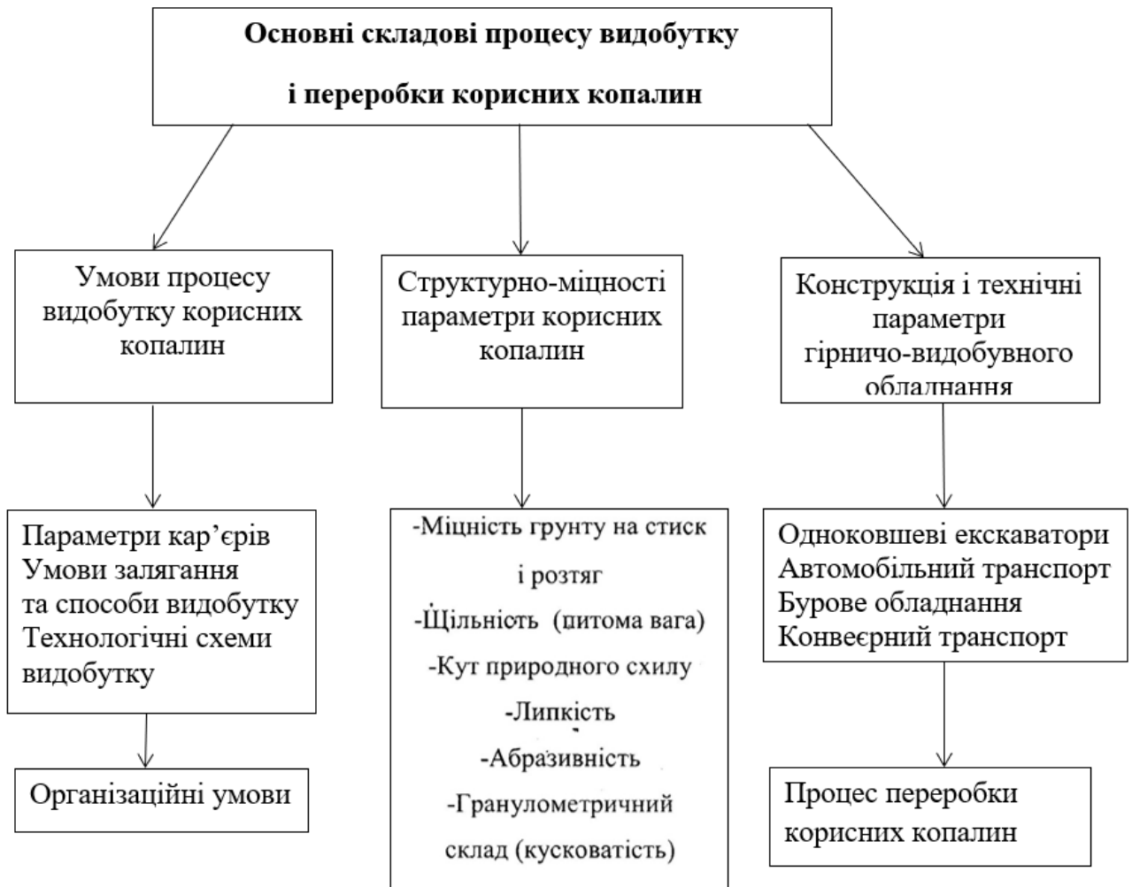
Рис. 1.1 – Схема взаємозв'язку гірничо-технічних умов кар'єрів з механічними властивостями ґрунтів і номенклатурою гірничо-видобувного і транспортного обладнання
