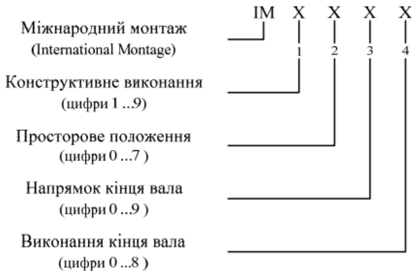
Рисунок 3.1 – Шифрування конструктивного виконання електричних машин
