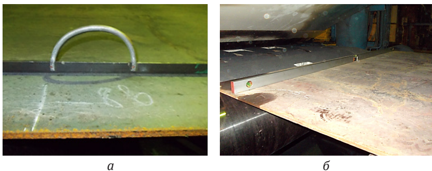
Рисунок 3.35 – Виміри дефектів площинності листа після правки: а – хвилястості; б – коробуватості
