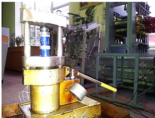
Рисунок 3.14 – Тарування кільцевих месдоз на гідравлічному пресі
