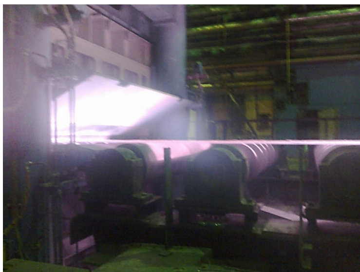
Рисунок 3.28 – Вихід металу із ЛПМ ТЛС 2800 АМЗ
