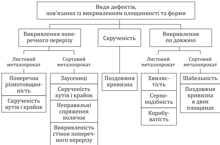
Рисунок 1.1 – Класифікація дефектів площинності та форми металопрокату [1]
