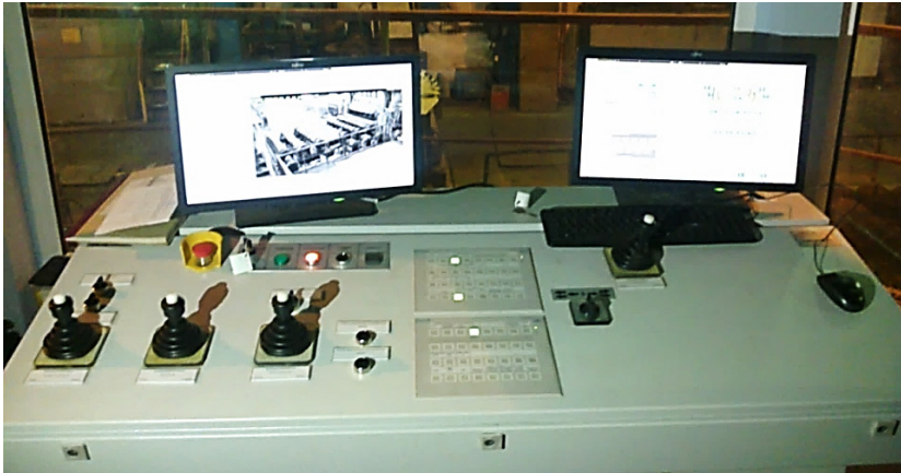
Рисунок 3.25 – Інтерфейс керуючої програми (а) і пульт керування (б) ЛПМ ТЛC 2800 АМ3
