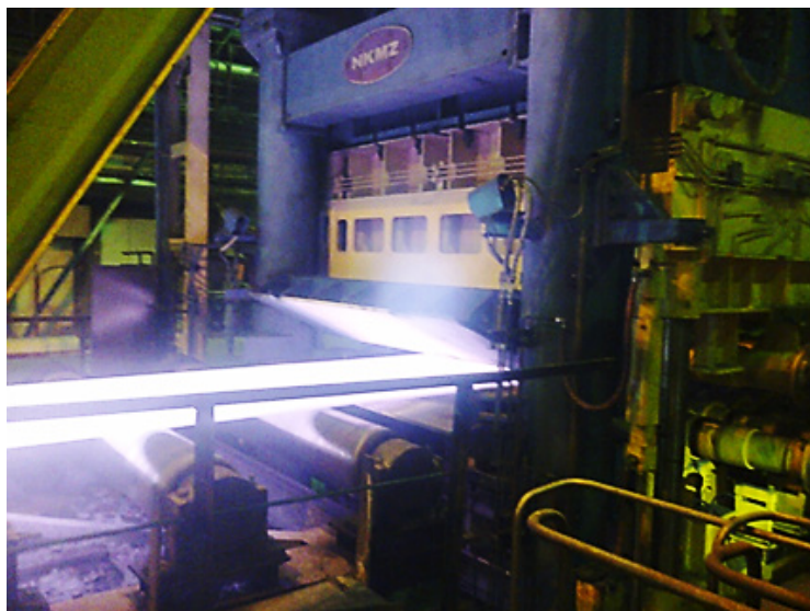
Рисунок 3.27 – Вхід металу в ЛПМ ТЛС 2800 АМЗ
