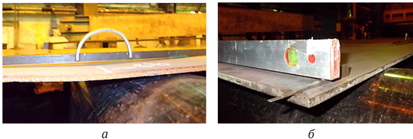
Рисунок 3.34 – Виміри товщини металу, що виправляється, і вихідних дефектів площинності: а – хвилястості; б – коробуватості
