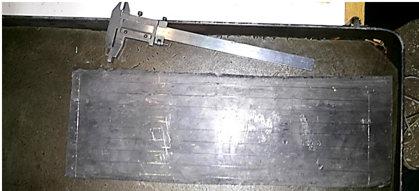
Рисунок 3.17 – Загальний вигляд листів зі свинцю, використовуваних при експериментальному дослідженні
