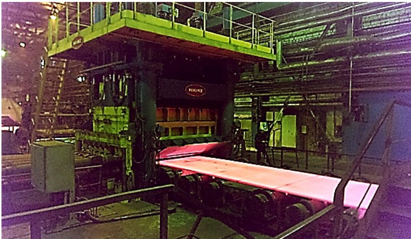
Рисунок 4.20 – Загальні види багатороликової листопривальної машини товстолистового стану 2850
