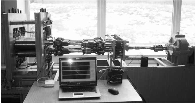
Рисунок 3.1 – Загальний вигляд лабораторної листопробірної машини 9 \times 100 \times 250 , призначеної для експериментального дослідження процесу правки відносно товстих листів
