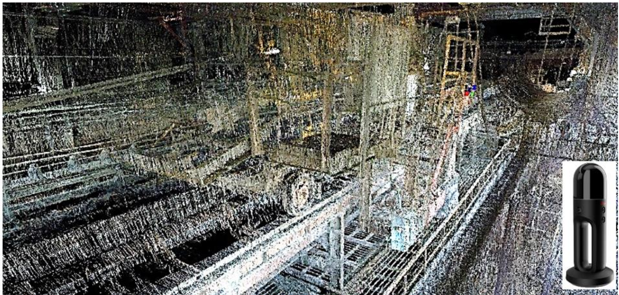
Рисунок 2 – Кольорова хмара точок. Результат лазерного сканування портативним ручним лазерним 3D сканером Leica BLK2GO. Надбункерна ділянка РЗФ-1 ПРАТ ІНГЗК. Автостела конвеєра О-3
