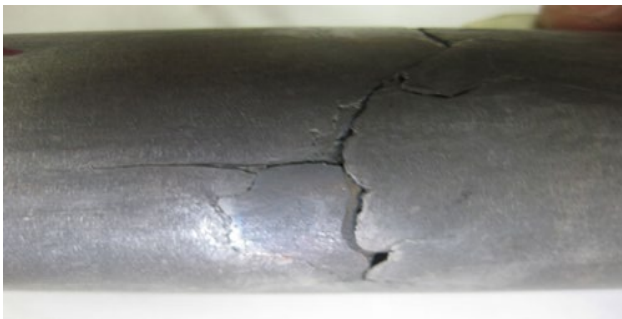
Рис. 2.79. Рваніна на поверхні холоднодеформованих труби
