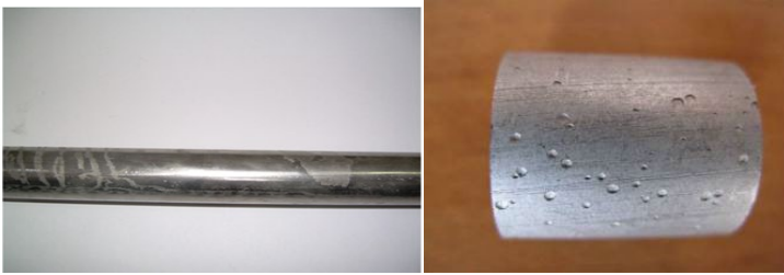
Рис. 2.78. Розтрав на зовнішній поверхні холоднодеформованих труб
