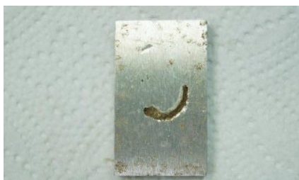
Рис. 4.14. Зовнішній вигляд зразка дуплексної нержавіючої сталі після випробувань на щілинну корозію
