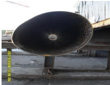
Рис. 2.74. Відхилення діаметра і підвищена овальність
