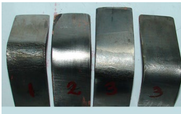
Рис. 4.15. Зразки після випробувань на стійкість до МКК
