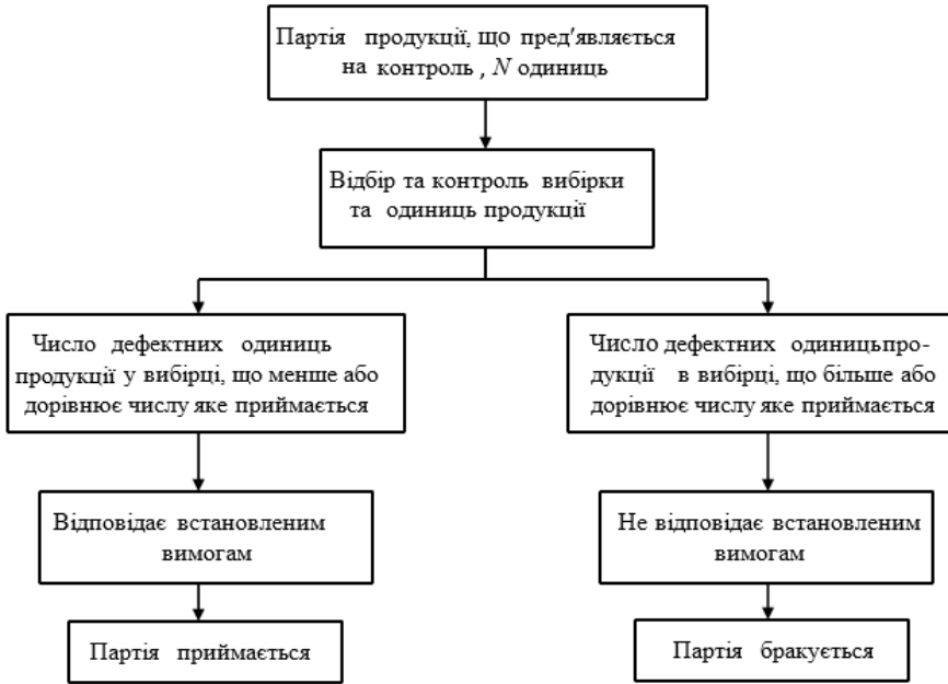
Рис. 5.20. Схема одноступеневого плану вибіркового контролю
