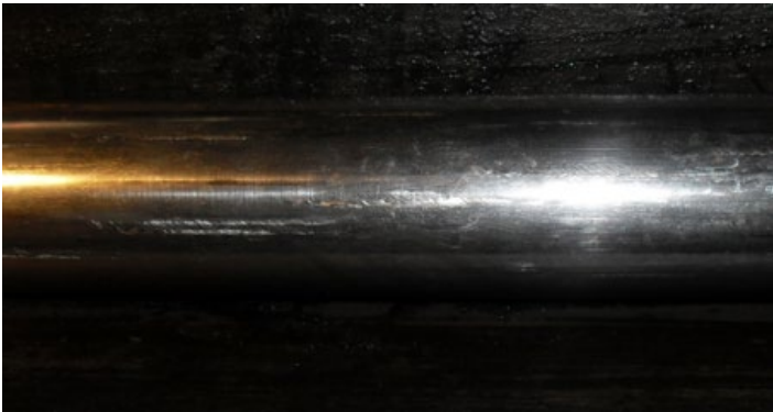
Рис. 2.77. Відбитки на зовнішній поверхні холоднодеформованих труб
