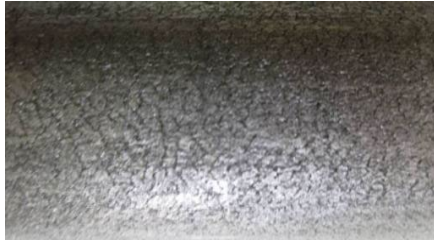
Рис. 2.72. Лускатість поверхні труб
