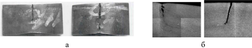
Рис. 2.87. Тріщина по ліквациї (хімічній неоднорідності): а – зовнішній вигляд; б – вид в перерізі
