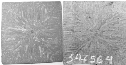
Рис. 2.15. Розвинена стовпчаста структура литої заготовки
