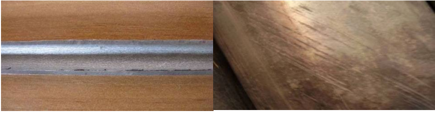
Рис. 2.80. Внутрішні різки холоднодеформованих труб
