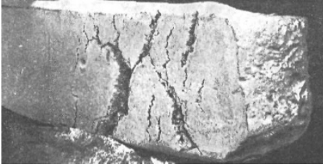
Рис. 2.25. Зливок із грубими рванинами після перших обтиснень під час прокату
