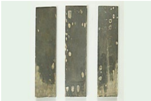
Рис. 4.17. Зразки після випробувань в автоклаві (3,5 % NaCl, T = 110 °C)
