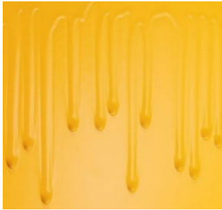
Рис. 2.100. Напливи на лакофарбовому покритті
