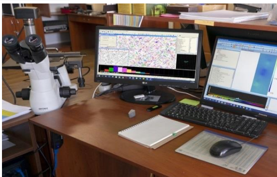
Рисунок 13.13 – Дослідження мікроструктури за допомогою спеціалізованого програмного забезпечення
