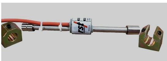
Накладний датчик VWSG-A-CON
