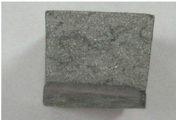
Рисунок 13.10 – Зовнішній вигляд зламу ударного зразка
