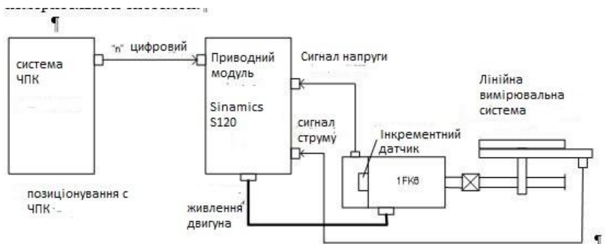
Цифрове керування приводом подачі з прямою реєстрацією положення
