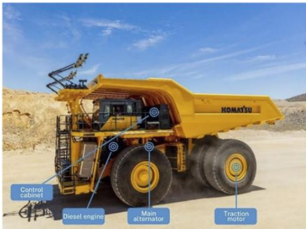
Рисунок 2.9 - Ідентифікація критичних компонентів на вантажівці Komatsu 930E-4SE
