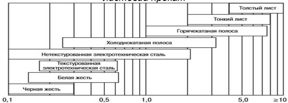
Рисунок 5.2 – Умовний поділ відносно товстий та відносно тонкий листовий прокат
