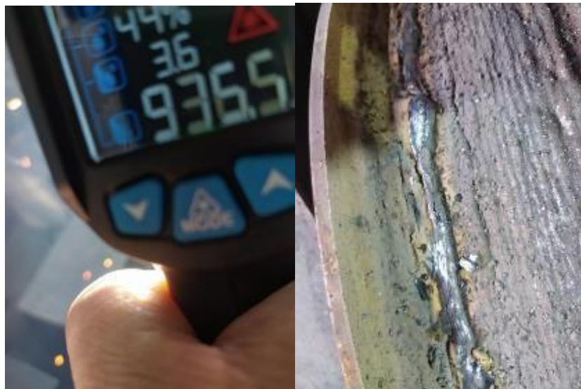
Рис 3.8 Результати наплавки згідно режиму 2
