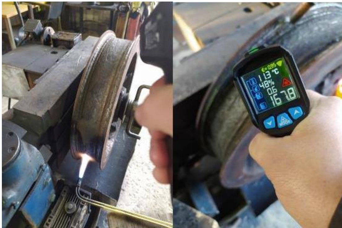
Рис. 3.4 Підігрів кранового колеса
