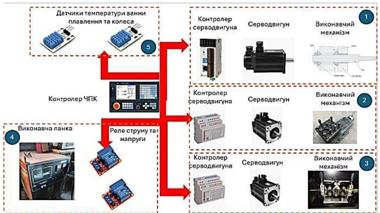
Рис 3.17 Схема ЧПК наплавлювального верстата
