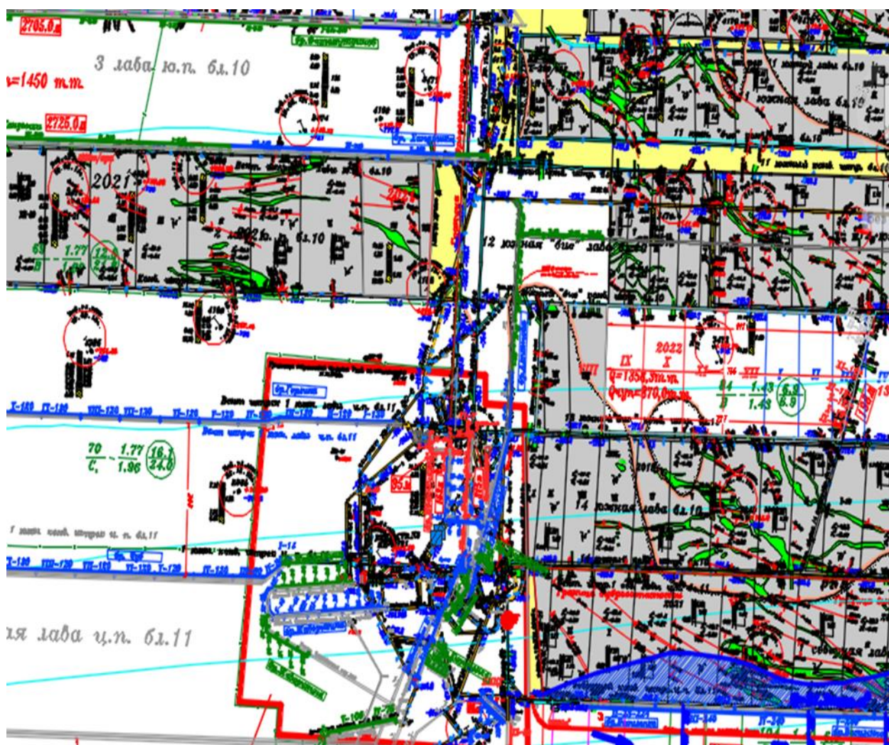
Рисунок А1. Фрагмент плану гірничих виробок блоку 11 з програмою розвитку робіт
