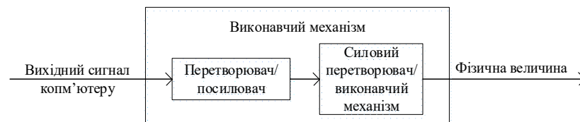
Рисунок 8.2 – Складові елементи виконавчого механізму
