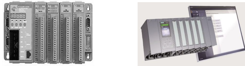
Рисунок 3.5 – Контролери серії I8000 і Siemens Simatic S7-1500
