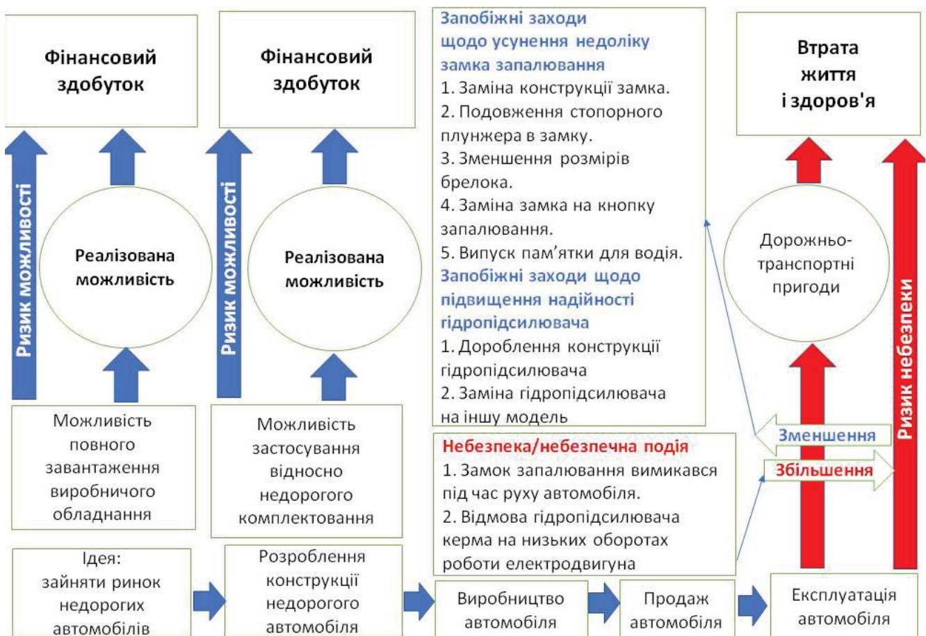
Рисунок. Взаємозв'язок між можливостями цілодобового завантаження виробничого обладнання і здешевлення марки через використання дешевого комплектування та появою небезпек, які призвели до ДТП
