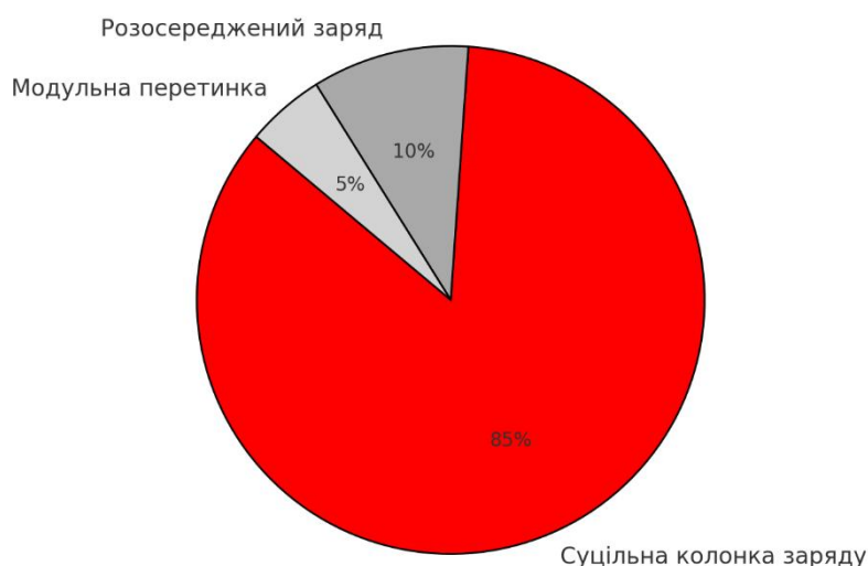
Рисунок 3.7 – Співвідношення використання конструкцій свердловинних зарядів, які застосовуються на кар'єрі ПрАТ «ІНГЗК»
