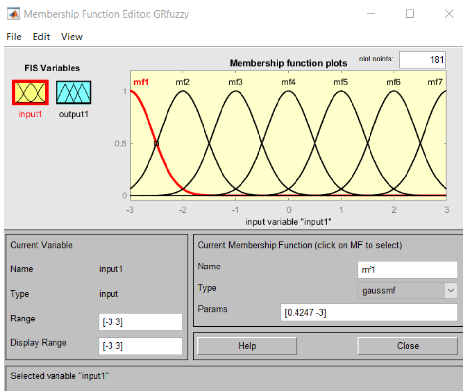
Рисунок 3.7 - Приклад налаштування головного вікна редактора Membership Function Editor
