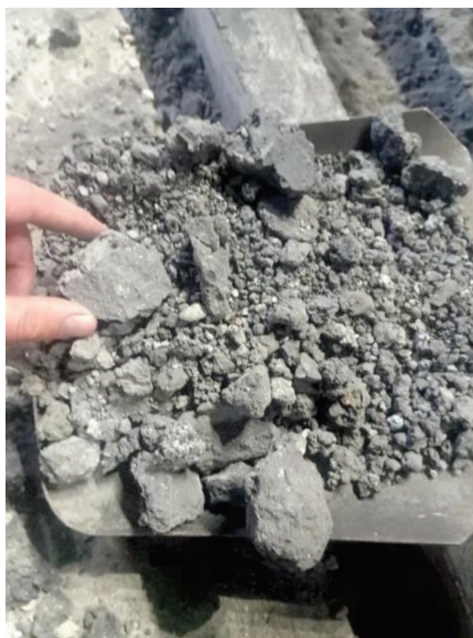
Рис. 4. Загальний вигляд флюсу марки N
