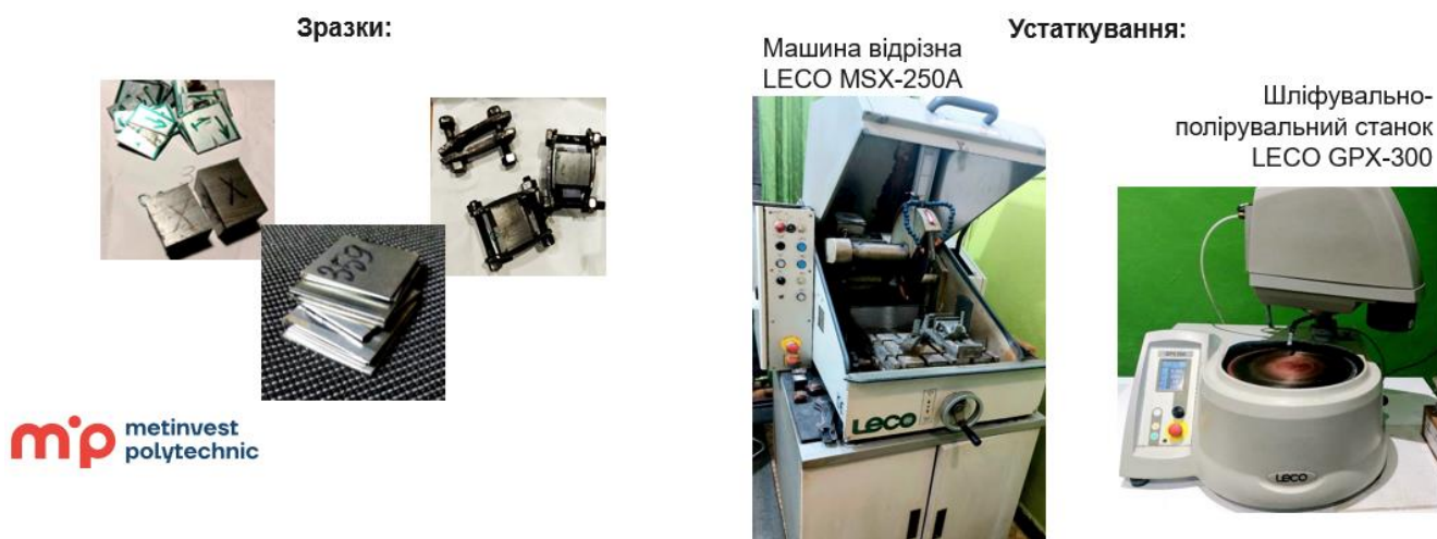
Рисунок 4.4 - Устаткування пробо підготовки для мікроаналізу та готові зразки
