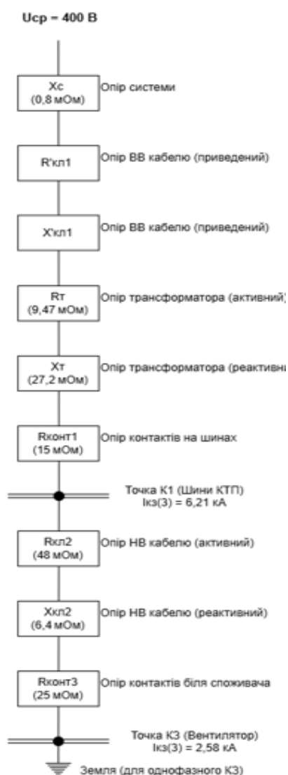
Рисунок 2.8 – Схема заміщення для розрахунку струмів трифазного короткого замикання в точках К1 та К3
