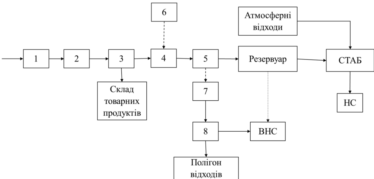
ВНС – водопровідна насосна станція; НС – насосна станція; СТАБ – стабілізатор напруги для насосної станції; 1 - усереднювач; 2 – насос; 3 - відкритий гідроциклон; 4 - шайбовий вузол; 5 - тонкошаровий відстійник; 6 – вугільний склад; 7 – бак флокулянту; 8 – резервуар освітленої води
