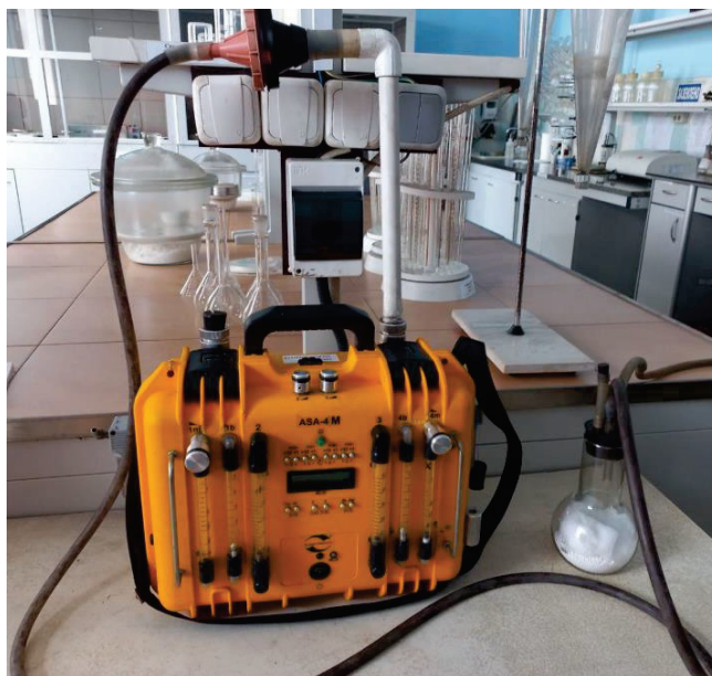
Рисунок 2.7 – Під'єднання аспіратуру ASA – 4М до фільтра і колби з вологовідділювачем
