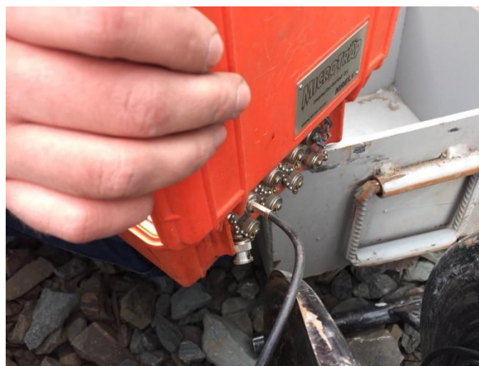
Рис.4.2 Комутація коаксіального кабелю з приладом в день виробництва МВ.
