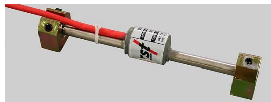
Наварний датчик деформації VWSG-A
