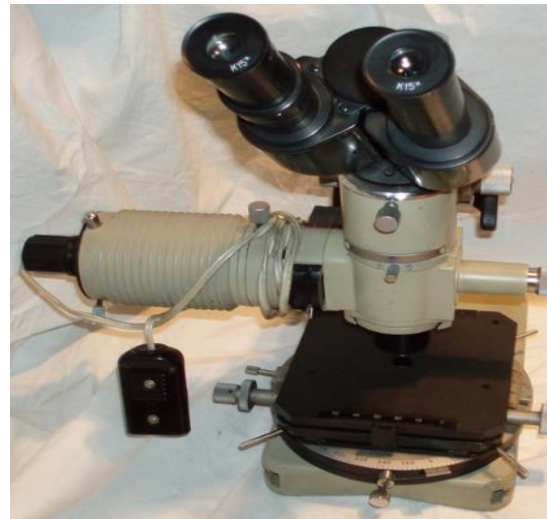
Рисунок 13.7 – Переносний металографічний мікроскоп
