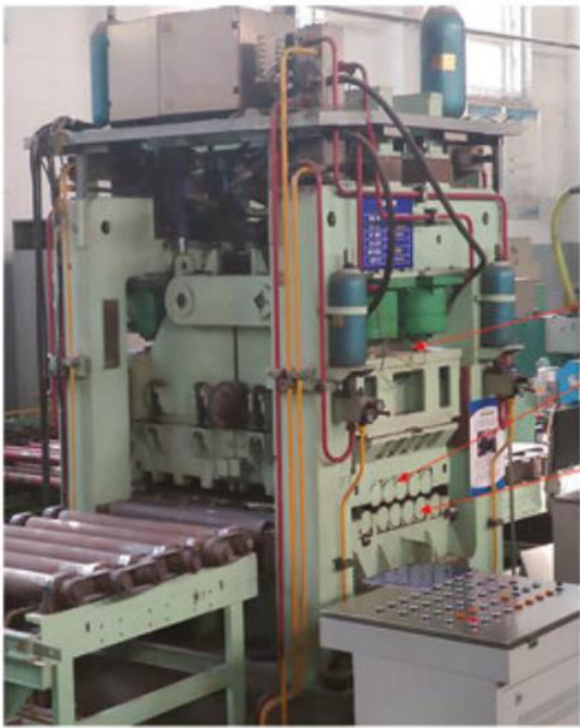
Рисунок 2.1 - Листоправильна машина з паралельним розташуванням роликів
