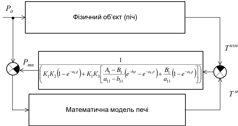
Рисунок 4.6 - Структурна схема додавання моделі для оцінки теплових втрат
