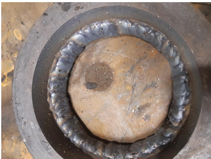
Рис. 4.2. Загальний вигляд напавленої матриці для пресування
