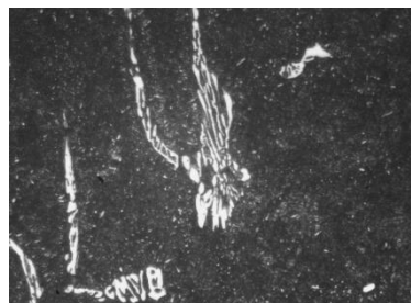
з) гартування 1025 °С, відпуск 850 °С
