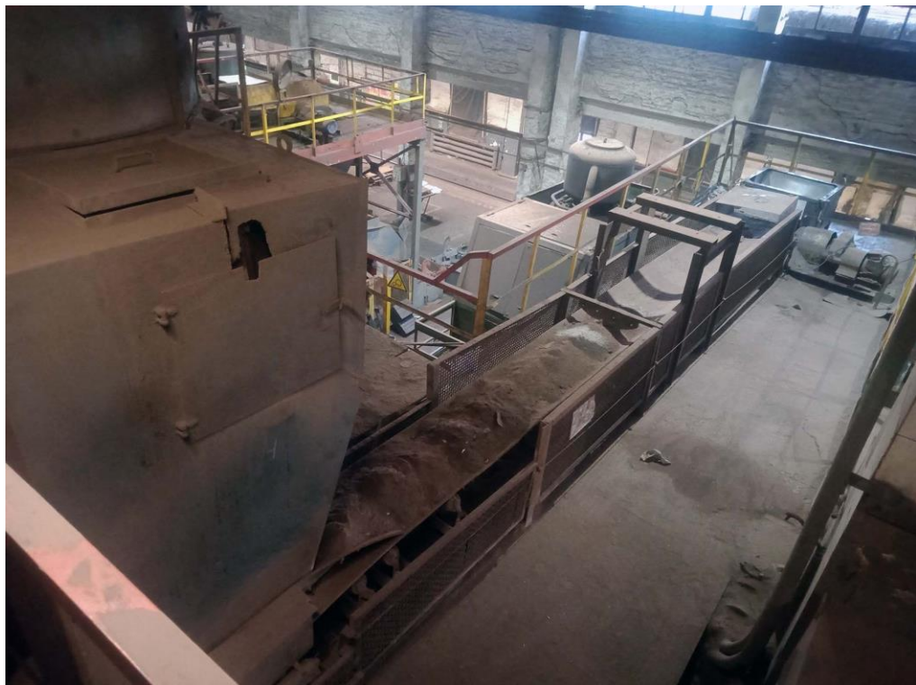
Рисунок 1.5 – Шибер змішувача та транспортер
