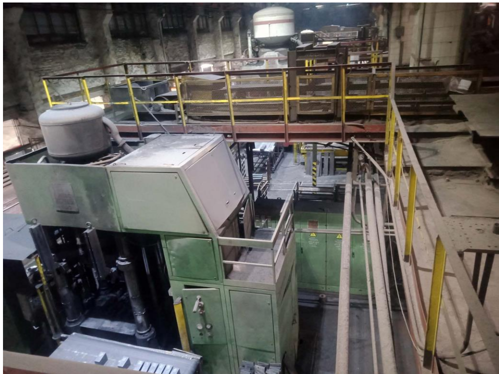
Рисунок 1.6 – Транспортер завантаження в прес та прес з виробництва вогнетривів
