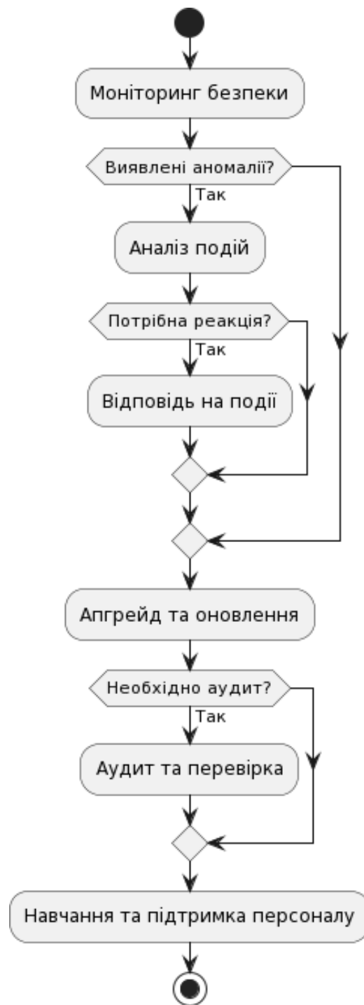
Рисунок 4.4 – Діаграма, яка формалізує логіку діяльності на етапі моніторингу та апгрейду систем захисту у процесі удосконалення кібербезпеки інформаційних систем з використанням методів машинного навчання
