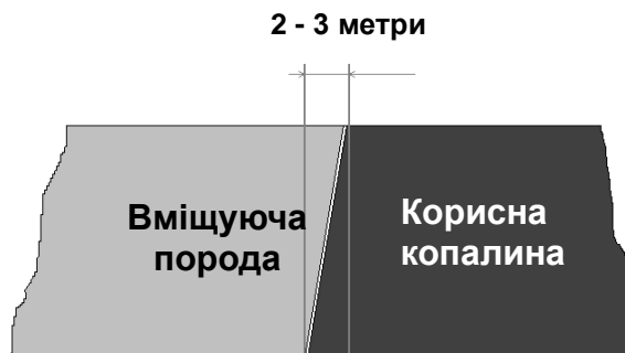
Рис.1а – Зона контакту корисної копалини з вміщуючою породою до підривання.
