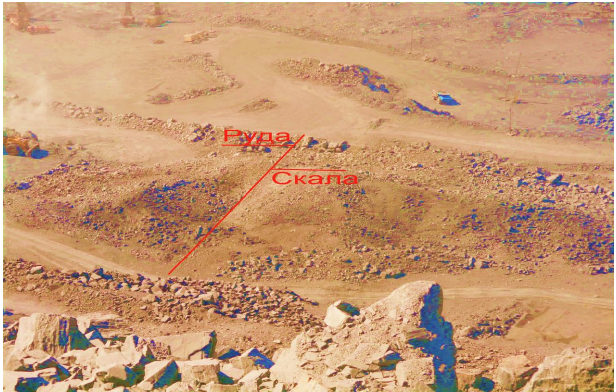
Рис.5. Форма розвалу та поверхні підірваного блока № 84 гір. - 315м.
