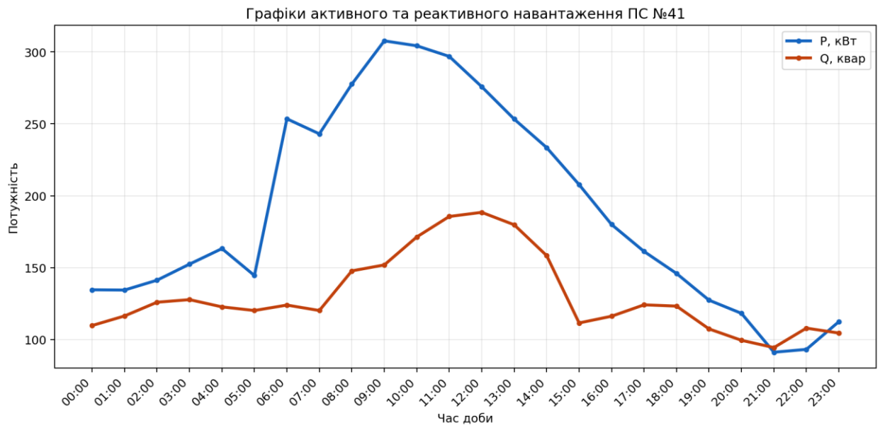
Рисунок 2.1 – Типові графіки активного та реактивного навантаження ПС №41
