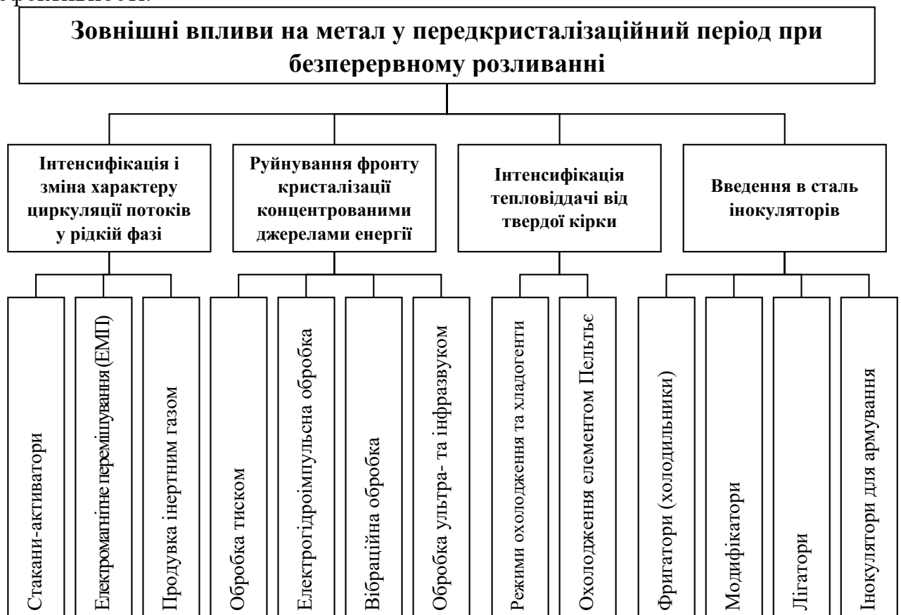
Рисунок 1.1. Класифікація методів зовнішнього впливу на метал у передкристалізаційний період при безперервному розливанні сталі
